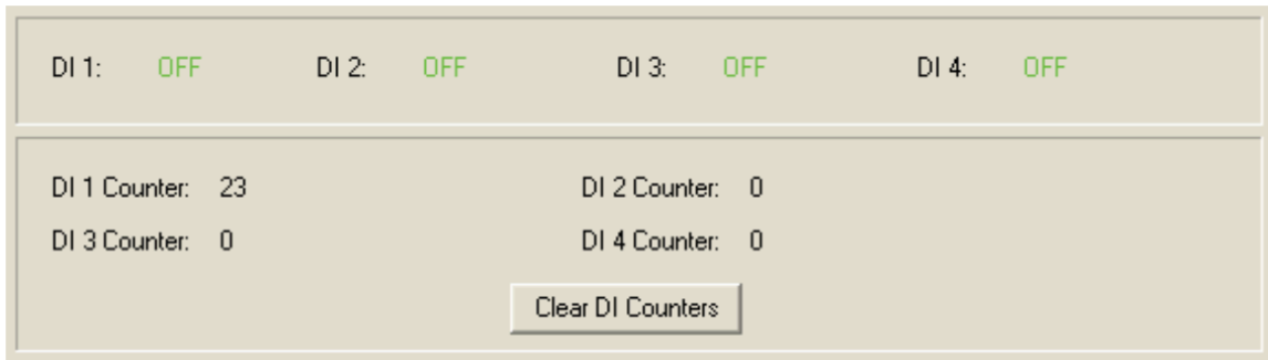
Fig.3-98 DI counter and status display
